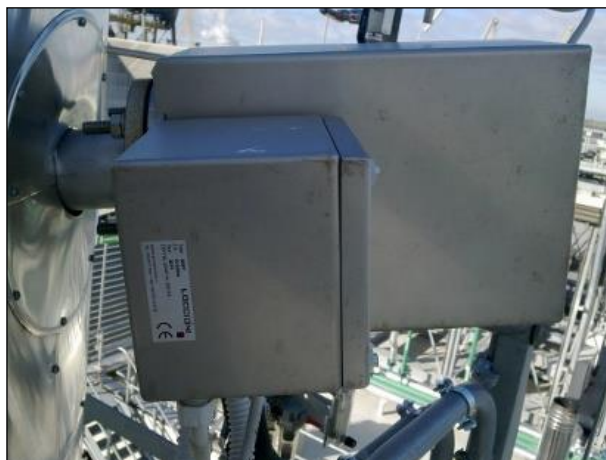
Sinottico e Foto esterno sonda prelievo gas tipico
